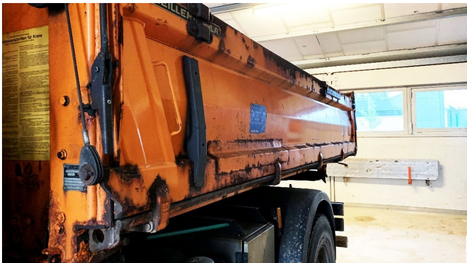
Bild: Verrostete Bordwand
