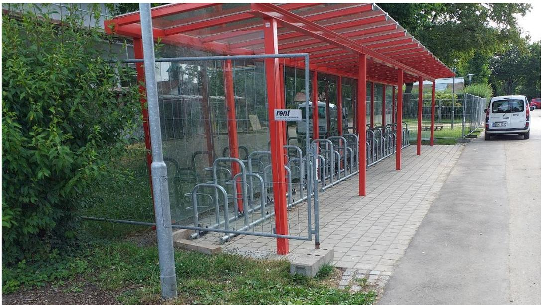
Abbildung 7-7: Gut geeignet: Anlehnbügel mit Vorderradfixierung, überdacht
