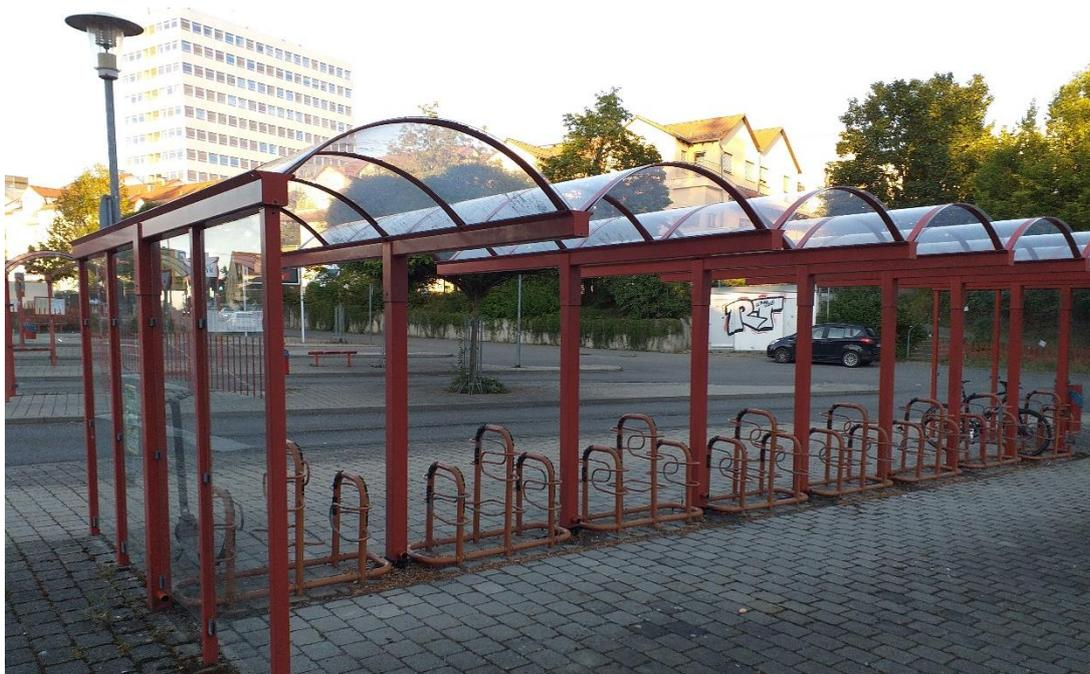
Abbildung 7-1: Geeignete Fahrradständer: Anlehnbügel mit Vorderradfixierung
